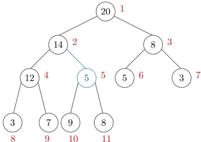
每次跟较大的子节点比较替换，直到渗透到合适的位置。
